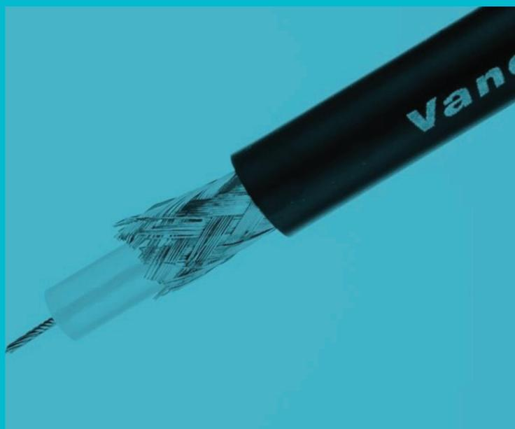
Analoge Videoübertragung bis zu 100 Meter. Geeignet für S/PDif Digital Audio, Wordclock und 360 Mb/s SD Digital Video bis zu 138 Meter. Verwendet Quetschverbinder vom Typ RG59.
